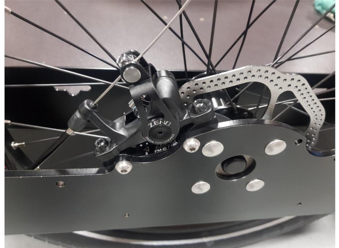
Si les plaquettes ne sont plus parallèles au disque de frein Il est possible de réaligner l'étrier en dévissant les 2 vis M6 de support avec une clé Allen 5mm.
