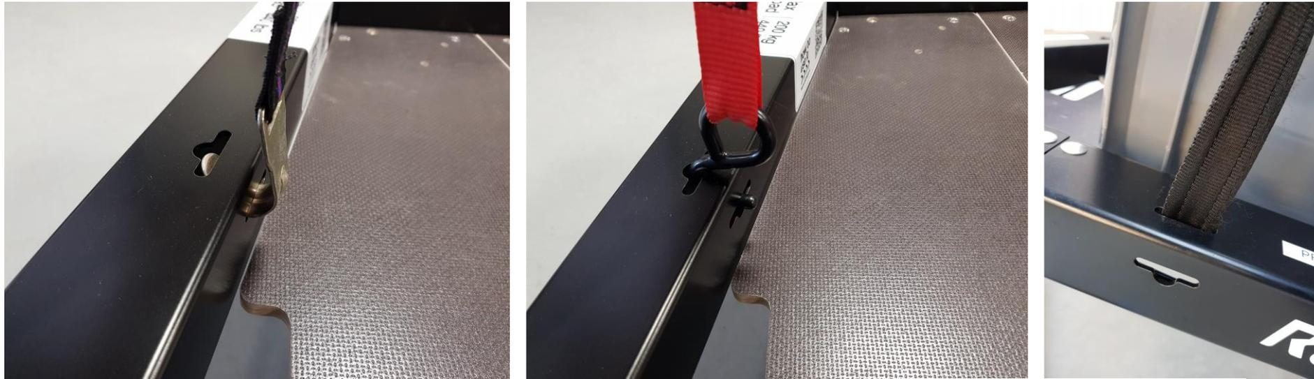
Privilégier l'arrimage de la charge perpendiculairement à l'axe de la remorque, avec plusieurs sangles, afin d'arrimer les caisses en blocs indépendants
