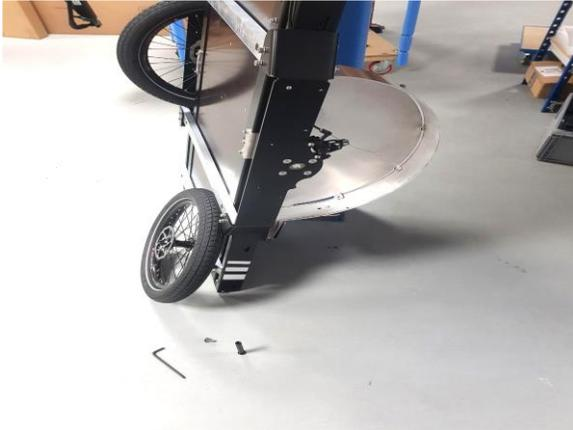
2. Desserrer et retirer la vis au niveau de l'axe de la roue à démonter (Allen 6mm)
