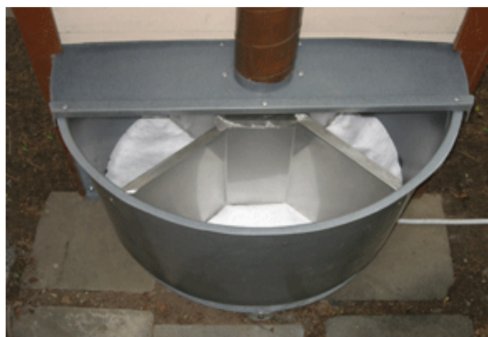
Compartiments du compost et ventilation
